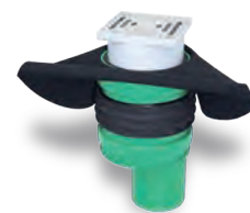
KRASO® Afvoerput Type FS - RS met folieflens vorstbestendig - met terugstuwbe- veiliging -
